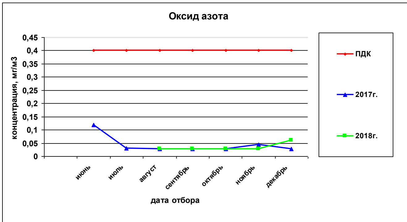
Рисунок 32— Сравнительная характеристика изменения концентрации оксида азота в атмосферном воздухе на перекрестке ул. Юрша-Уинская за 2017 и 2018гг.
